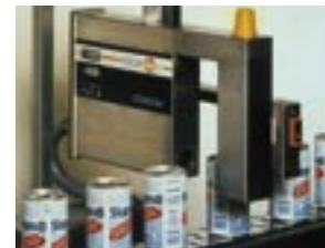
Εικόνα 3: Συσκευή μέτρησης στάθμης με ραδιενεργό πηγή σε γραμμή παραγωγής
