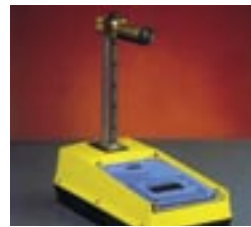
Εικόνα 2: Συσκευή μέτρησης υγρασίας-πυκνότητας εδάφους
