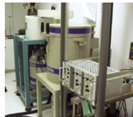
Εικόνα 24: Ο ανιχνευτής υπερκαθαρού γερμανίου του εργαστηρίου Ελέγχου Ραδιενέργειας Περιβάλλοντος
