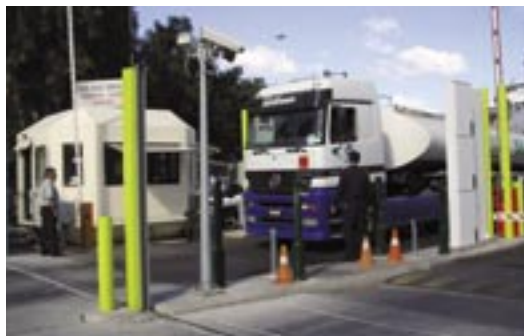
Εικόνα 3: Σύστημα ανίχνευσης ραδιενέργειας στις πύλες εισόδου στη χώρα για τον έλεγχο των φορτίων που μεταφέρονται με φορτηγά
