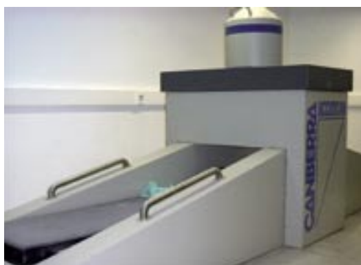
Εικόνα 25: Μετρητής ολόσωμης ακτινοβολίας για μέτρηση εσωτερικής ραδιορρύπανσης
