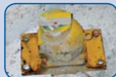
Συσκευή μέτρησης πυκνότητας ροής με πηγή Cs-137
