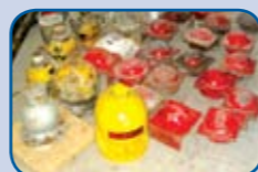
Σταθερές κλειστές ραδιενεργές πηγές εντός θωράκισης
