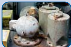
Βιομηχανικές πηγές Cs-137 και Co-60
