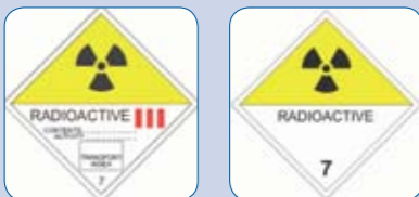
Σήμανση ειδικών δοχείων μεταφοράς ραδιενεργών πηγών
