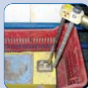
Φορητή συσκευή μέτρησης πυκνότητας και υγρασίας εδάφους με πηγές Am-241 και Cs-137
